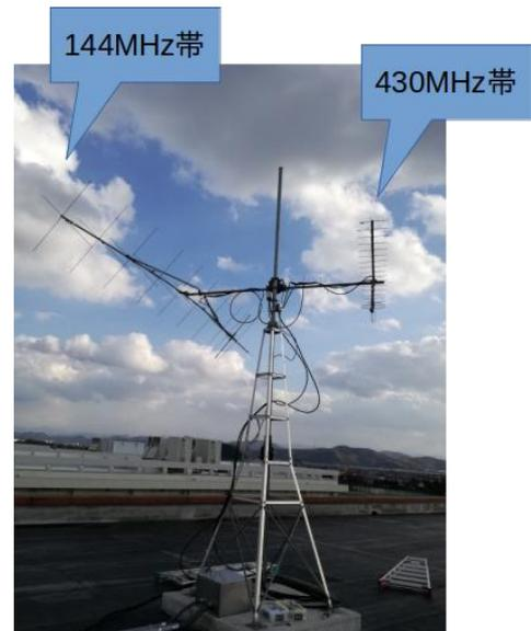
図4 衛星通信向けのアンテナ
